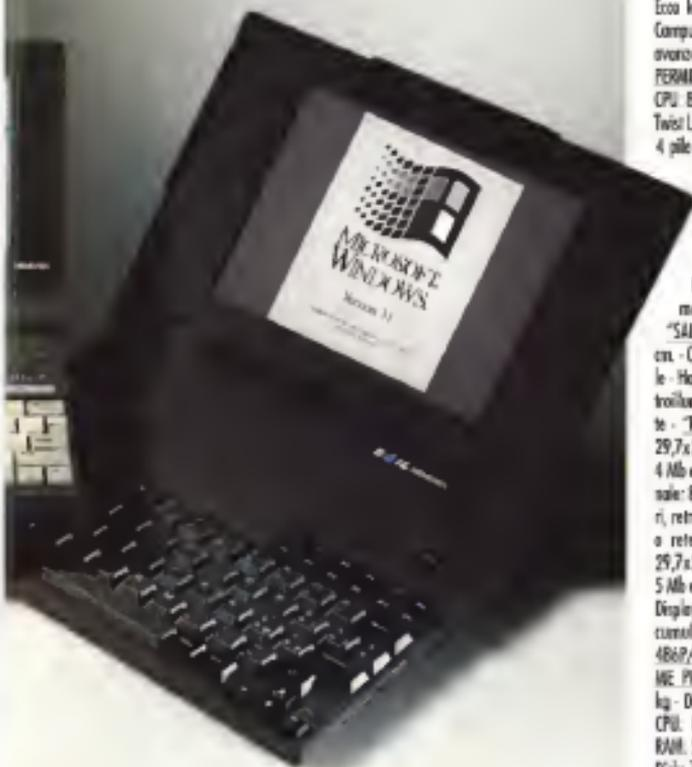
Ecco la nuova gamma di NOTEBOOK PC MEMOREX Computer Supplies: superportatili con caratteristiche avanzatissime e prestazioni senza compromessi. "SUPERMINI" Peso: 0,58 kg - Dim. 23,5x11x2,9 cm - CPU: 8088 a 7,16 MHz - RAM: 640 Kb - Display: Super Twist LCD 80 colonne x 25 righe - CGA - Alimentazione: 4 pile AA a rete - RAM CARD fino a 2 Mb opzionali.
